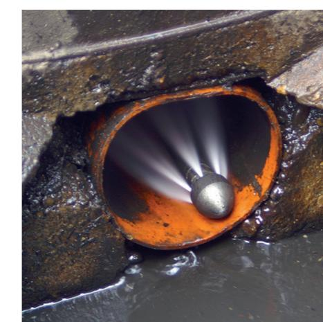
Reinigungsverfahren mit Spezialdrehdüsen und halbautomatisch geführten Hochdruckschläuchen (Roto-Fan®) befreien Rohrleitungen von härtesten Rückständen.
